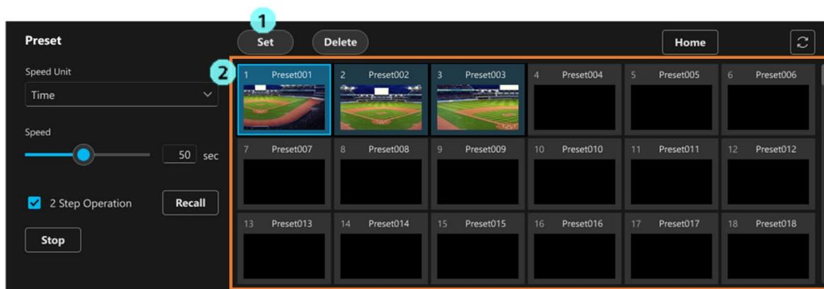
1. プリセット操作部の[Set]ボタンをクリックして、ボタンを ON 状態にします。
