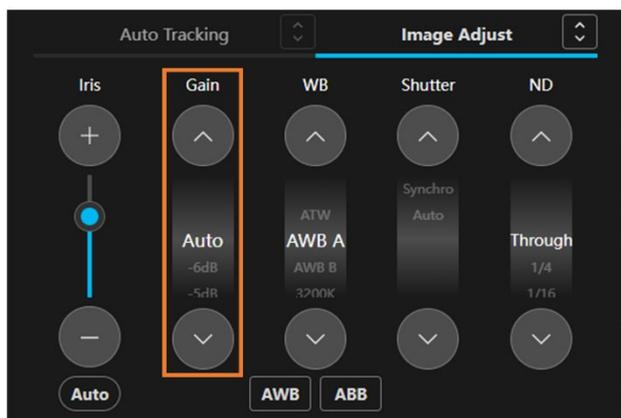
カメラコントローラー Image Adjust 操作部の Gain 部（上図枠線部）でカメラの Gain を設定できます。上矢印／下矢印ボタンをクリックすると設定値が変化します。
