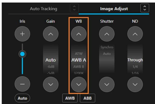
カメラコントローラー Image Adjust 操作部の WB 部（上図枠線部）でカメラの White Balance モードを設定できます。
