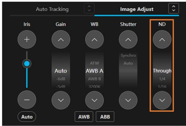
カメラコントローラー Image Adjust 操作部の ND 部（上図枠線部）でカメラの ND Filter を設定できます。
