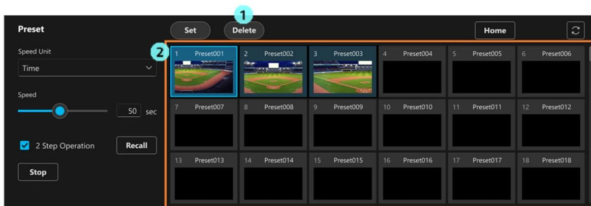
1. プリセット操作部の[Delete]ボタンをクリックして、ボタンを ON 状態にします。
